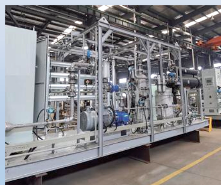
VOCs压缩冷凝膜法回收装置
